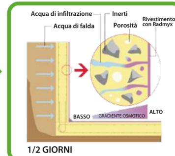
In caso di venute d'acqua persistenti in 7 giorni Radmyx® è in grado di sigillare fessure e porosità del calcestruzzo in maniera duratura preservando la struttura dal degrado.
