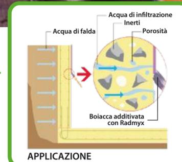
A differenza dei sistemi filmogeni tradizionali che bloccano le venute d'acqua per mezzo della loro capacità adesiva al supporto Radmyx® penetra per osmosi nella struttura lesionata e "intasa" progressivamente le fessurazioni presenti o formate nel tempo;
